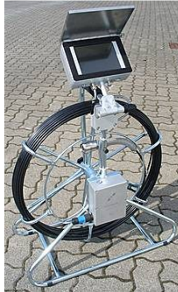
Schiebekamera mit Haspel und Aufzeichnungsgerät
