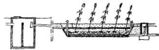
Pflanzenbeetanlage: wie im Sandfiltergraben siedeln Bakterien im Boden, die Pflanzen helfen bei der Belüftung.
